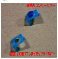
② センサーカバーはプラスドライバー1 本で簡単に交換できます。
