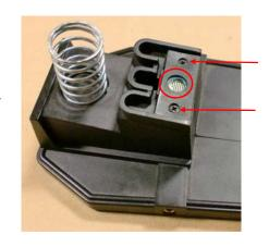
⑤ プラスチックプレートを外しセンサーカバーを露出させ、センサーカバーを外します。手で簡単に外すことができます。
