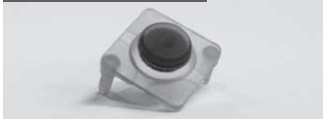
疲労により破けたセンサーカバー
