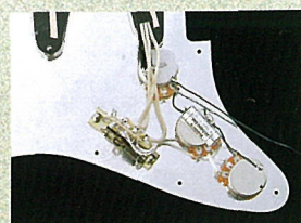
ELECTRIC CIRCUIT 配線材: ベルデン #8523 コンデンサー: ビタミンQ(オイル) セレクトスイッチ: CRL (5Way) アウトプットジャック: スイッチクラフト
